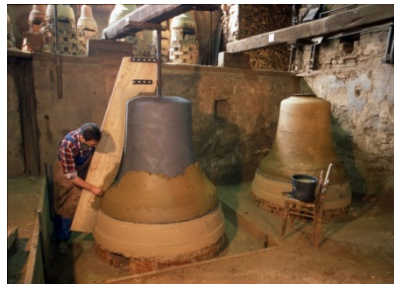
Bild 6 Schablonieren der Falschen Glocke
