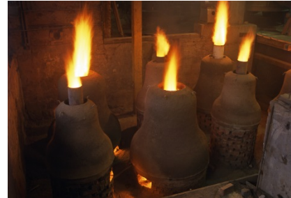
Bild 7 Trocknen der Glockenform durch Befeuern des Hohlraumes
