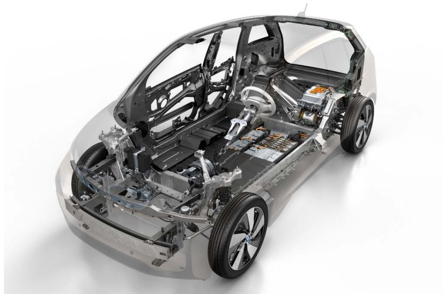
Aluminium- und CFK-Bauteile im BMW i3 (Quelle: BMW AG)
